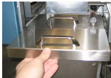
Kuva 4: Aseta kansi pannuun ja liu'uta öljyn liitinputki naarasimuliittimeen.
