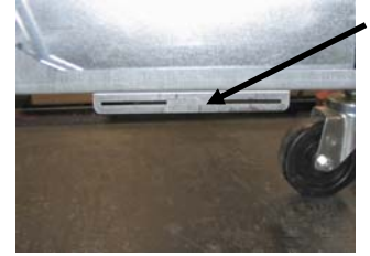
Kuva 1: Liitä kohdistuskiinnitin ATO-laatikon tuen pohjaan.
