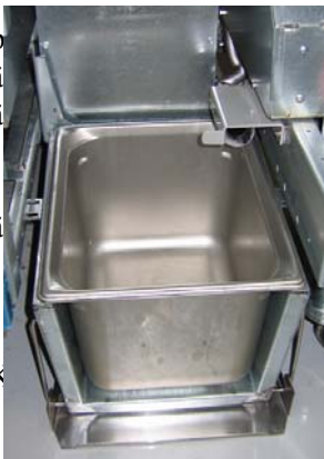
Kuva 3: Aseta sisäinen öljyvarastopannu sulatusyksikköön.
